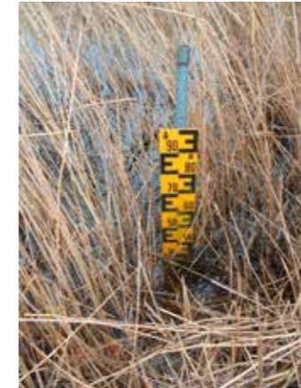
Lattenpegel zur Erfassung der Grabenwasserstände im offenen Graben
